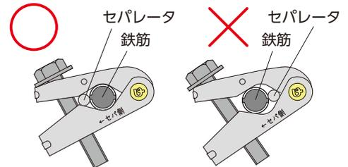
※セパレータは締付ボルト側に設置
